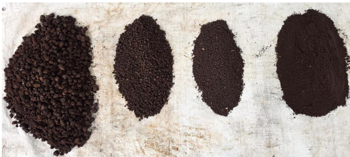
2. Ábra: A libickozmai gyevasércből aprítás és frakcionálás után előálló frakciók. Balról jobbra: 24-12mm, 12-6mm, 4-6mm, 0-4mm.
