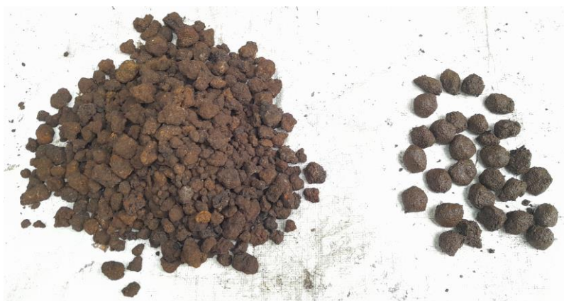
3. Ábra: A kísérletekhez használt 6-25mm-es szemcseméretű gyevasérc és a 0-6mm-es frakcióból kevés víz hozzáadásával készült granulák.
