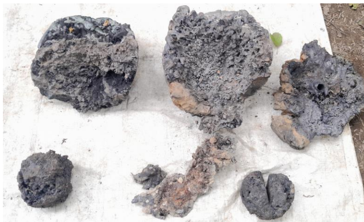
6. Ábra: Az első és a második próbakohóstítás salakmedvéi és vasbucái (a másodiknál a mellfal is egyben maradt).
