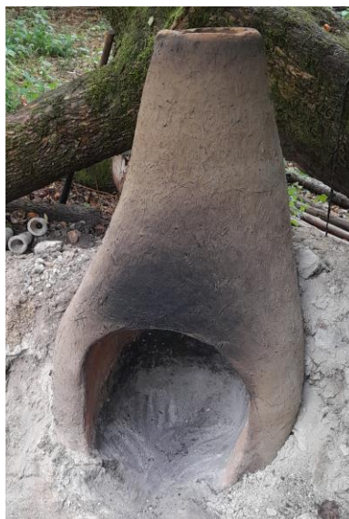
4. Ábra: A kísérletekhez használt avar kohómáslolat. Baloldalon: főbb méretek. Középen: a kohó mellfal nélkül kohósítás előtt. Jobboldalon: a kohó üzem közben.
