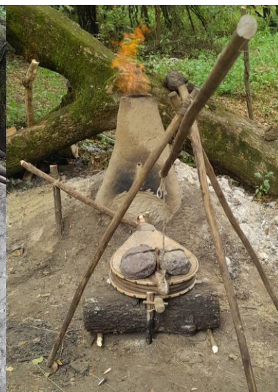
4. Ábra: A kísérletekhez használt avar kohómáslolat. Baloldalon: főbb méretek. Középen: a kohó mellfal nélkül kohósítás előtt. Jobboldalon: a kohó üzem közben.
