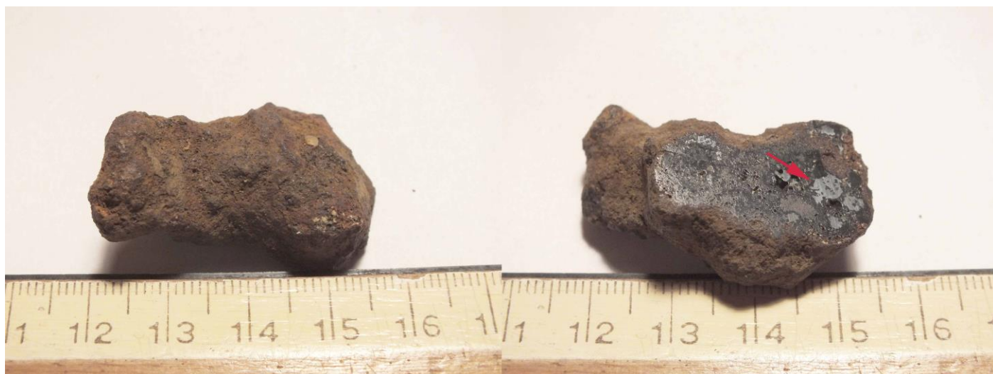
Metallográfiai vizsgálatra szánt vasrögminta. Az ábrán nyíllal jelölöm a metallográfiai vizsgálat során alaposabban megnézett kis vasgolyócskát.
