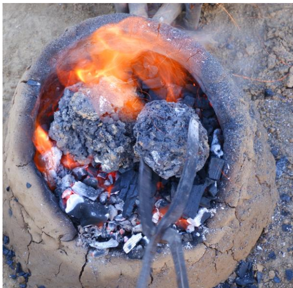
Az 1j és 1b bucák behelyezése a bucamáglyába és a bucamáglya üzem közben
