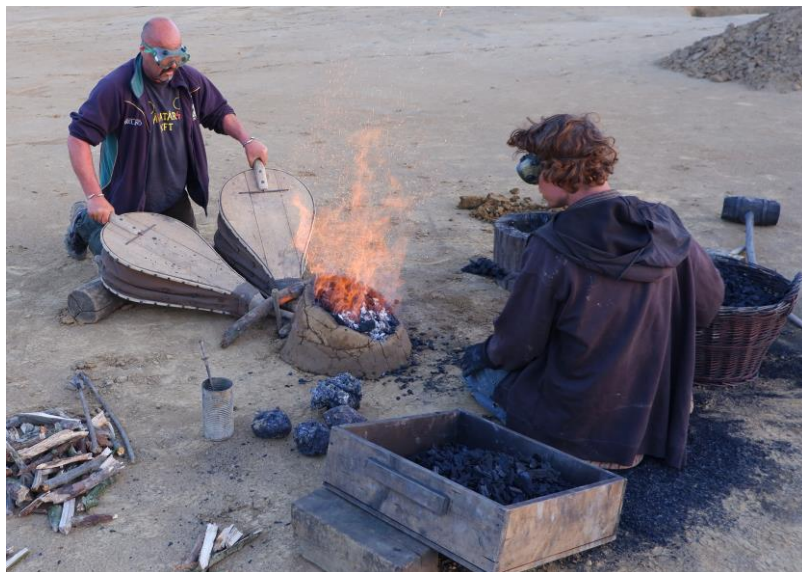
Az 1j és 1b bucák behelyezése a bucamáglyába és a bucamáglya üzem közben
