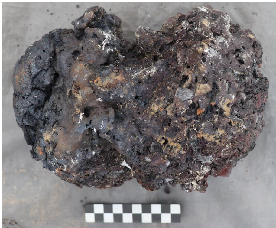
A bucamáglyából kikerült 6,7kg-os nagy buca. A bal oldalon a felső része, a jobb oldalon az alja a feltapadt salakmedvével
