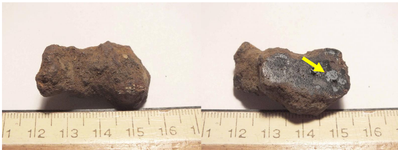
6. ábra: Metallográfiai vizsgálatra szánt vasrögminta. Az ábrán sárga nyíllal jelölöm a metallográfiai vizsgálat során alaposabban megnézett kis vasgolyócskát.
