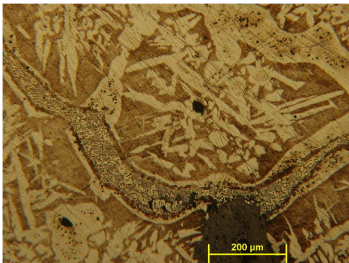
8. ábra: Eutektikum a szemcsehatárokon.
