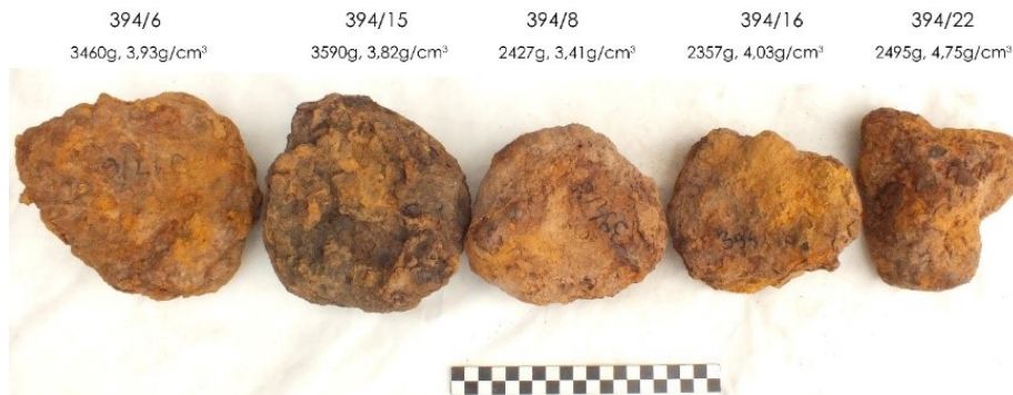
3. ábra: Az anyagvizsgálatra kiválasztott 5 jakab-hegyi vasbucá tömeg és sűrűségadatokkal. Fotó: Thiele Ádám
