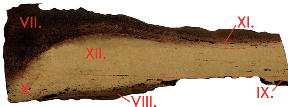
10. kép. A 2. minta főbb területei és az őket elválasztó kovácshesztési vonalak Fig 10. Main areas of sample 2 and the welding lines of the cross section
