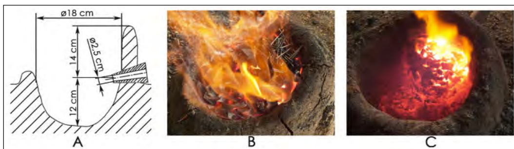
2. ábra. A szeghegesztős kísérlet oldalszeles kovácstűzhelyben. A) Méretek. B) Szegadag az izzó faszén kupac tetején. C) A fűvóka alatt-előtt összeállt salakos vasbuca a kísérlet végén
