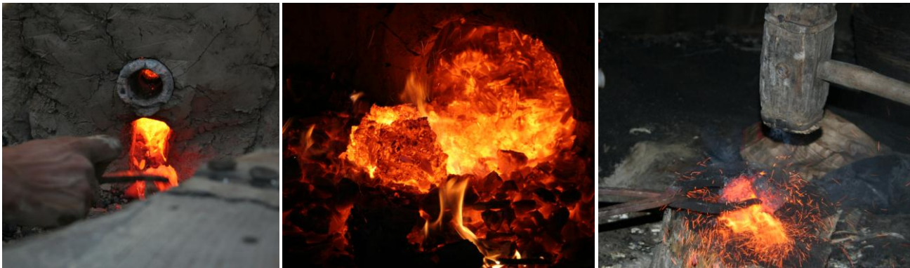
4. ábra: Balról jobbra: Salakcsapolás, az izzó vasbuca kihúzása, a vasbuca tömörítése.
