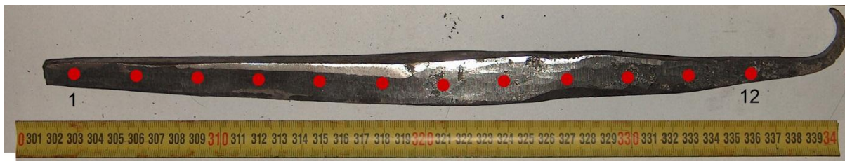
14. ábra: A 4. próbakohósítás vasbucájából kikovácsolt vasrúd és a kémiai összetétel mérési pontok
