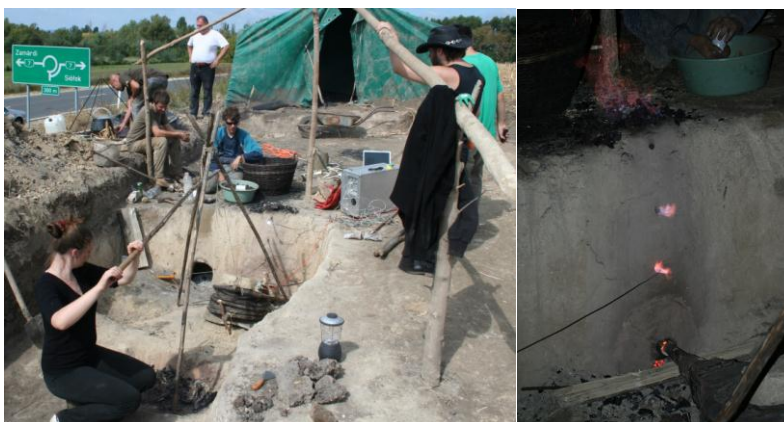
2. ábra: Balra: A műhelygödör a két bucakemencével (a baloldali üzem közben). Jobbra: a jobboldali bucakemence a mérési pontokkal.
