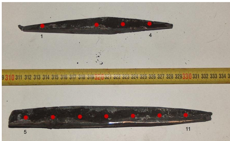
12. ábra: A 2. próbakohósítás vasbucájából kikovácsolt vasrudak és a kémiai összetétel mérési pontok
