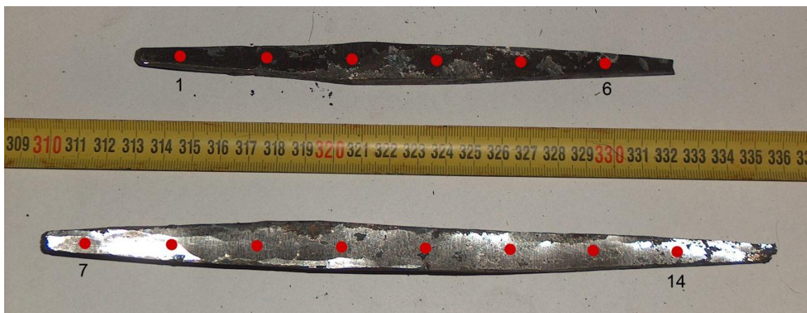
13. ábra: A 3. próbakohósítás vasbucájából kikovácsolt vasrudak és a kémiai összetétel mérési pontok
