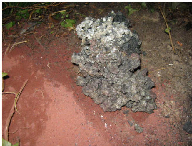
14. kép: Gyepvasércszemcsékből összesült konc
