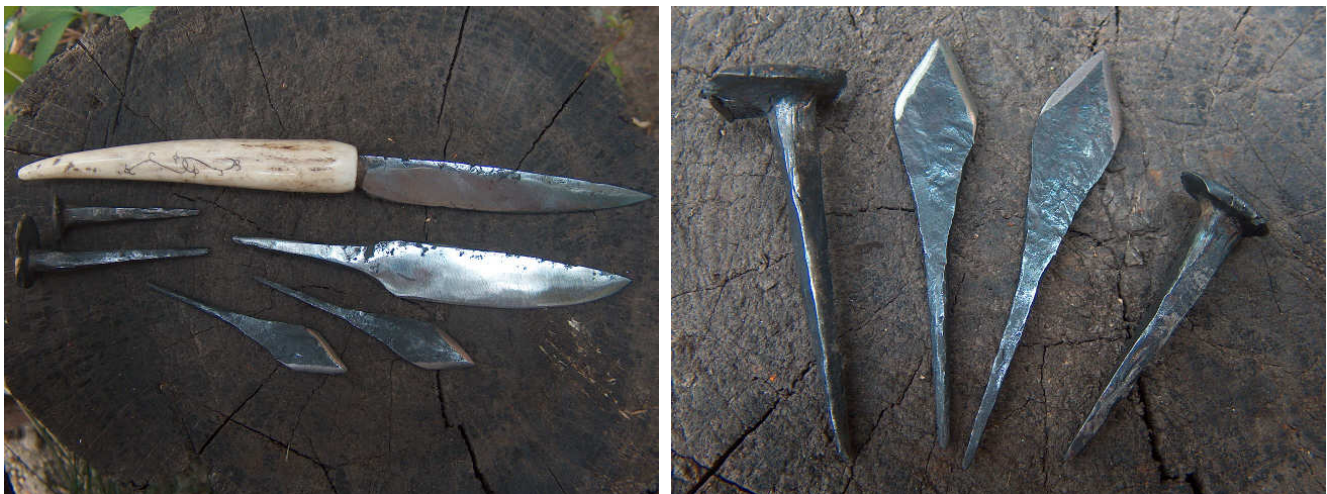
30-33. kép: A negyedik sikeres próbakohósítás és a kapott vasbucaából kikovácsolt vastárgyak.
