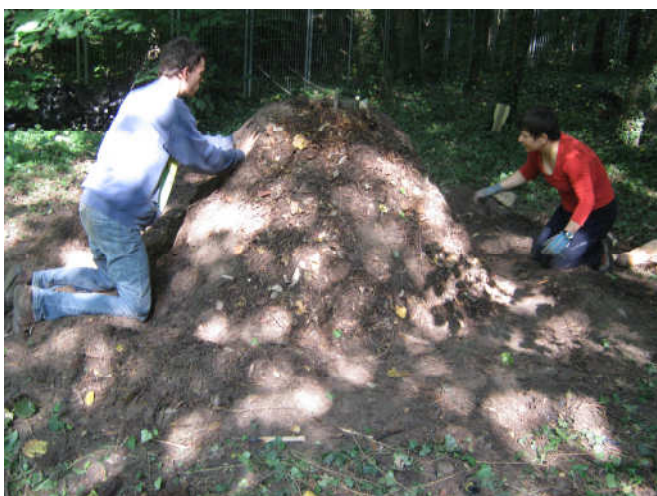
1-4. kép: Faszénégető boksa építése.
