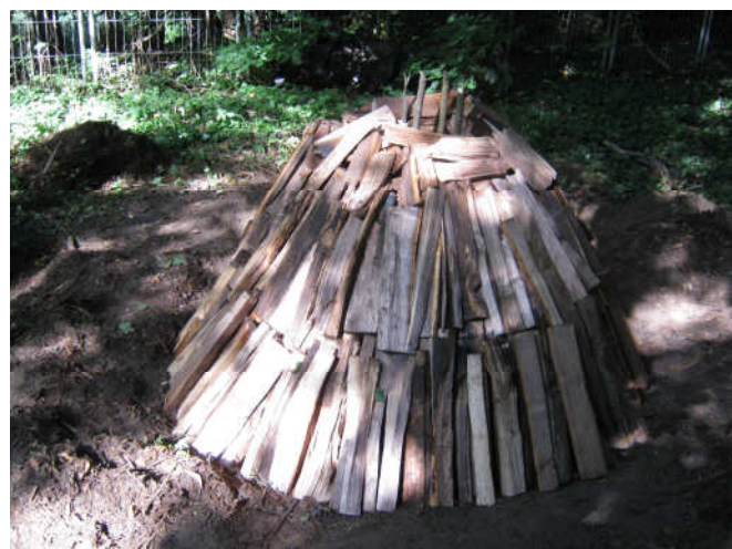
1-4. kép: Faszénégető boksa építése.
