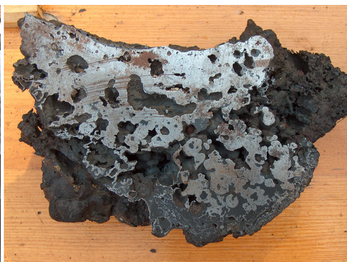
8. kép: A francia csapat vasbucájának keresztmetszete
