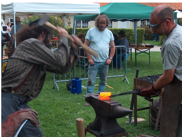
7. kép: Az angol csapat vasbucájának átkovácsolása
