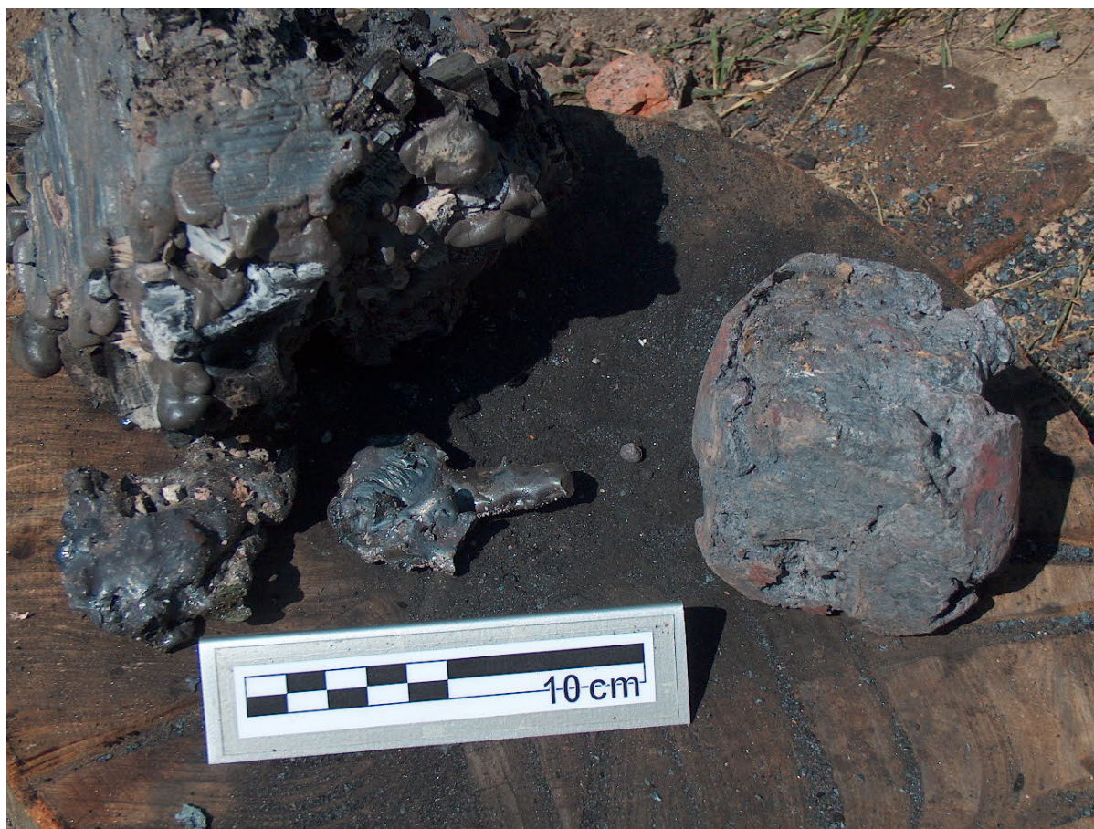
2. ábra: A május 6-i próbakohósítás eredményeképpen kapott vassalak (baloldalon) és tömörített vasbuca (jobbaldalon).
