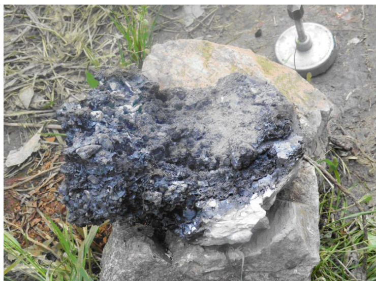
4. ábra: A kapott medve (alul a folyósalak összeolvadva a medence fenekével, felül, baloldalon vasrögök)
