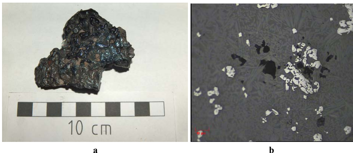
16. ábra: Folyósalakminta vizsgálata. – a ) Folyósalakminta; b) Folyósalakminta optikai mikroszkópos felvétele, 200-szoros nagyítás.
