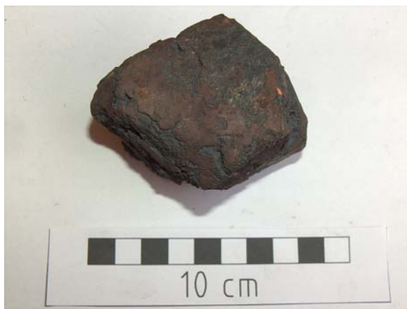
6. ábra: Vasbucák. – a) Szivacsos szerkezetű, tömörítetlen állapotú vasbucadarab, tömeg: 460gramm; b) Tömörített majd kocka alakúra kovácsolt vasbuca, tömeg: 760gramm.
