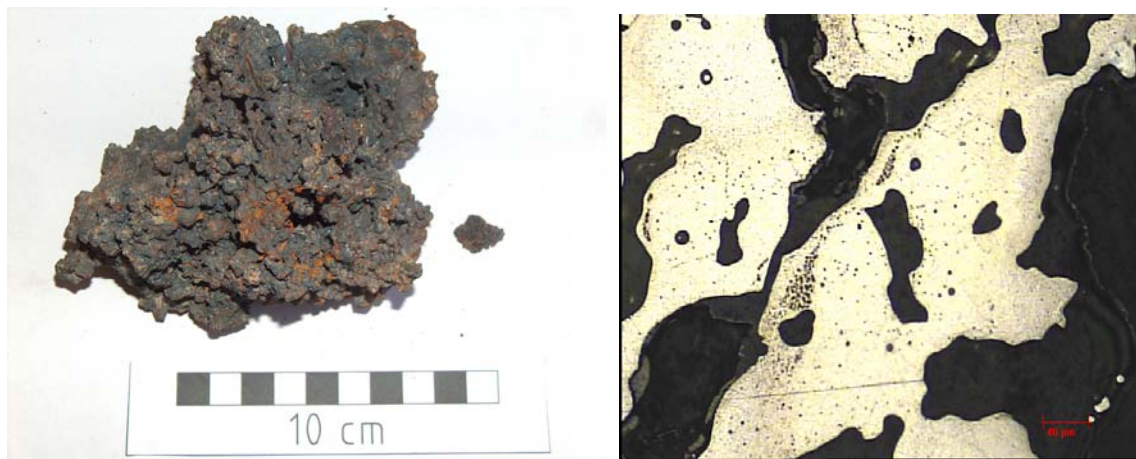
a b 30. ábra. A vasbuca állapota a bucakemence medencéjének viszonyai között. – a) A 19. próbakohászat tömörítetlen vasbucája; b) A vasbucáról származó minta metallográfiai csiszolata, 200-szoros nagyítás.
