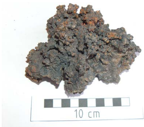
6. ábra: Vasbucák. – a) Szivacsos szerkezetű, tömörítetlen állapotú vasbucadarab, tömeg: 460gramm; b) Tömörített majd kocka alakúra kovácsolt vasbuca, tömeg: 760gramm.
