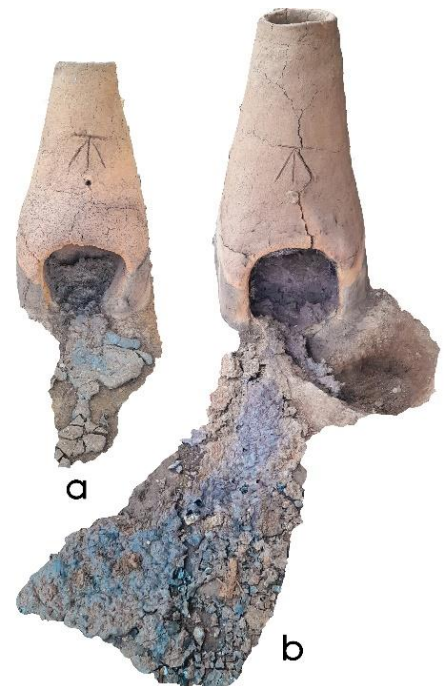
7. ábra: A 25-ös (a) és a 38-as (b) kohó az elé kifolyt folyósalakkal az I/2 és a II/1 kísérlet után.
