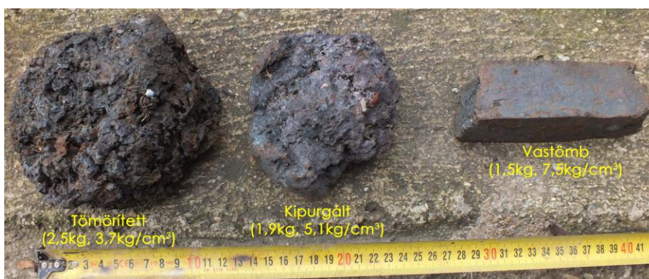
11. Ábra: Nagyjából azonos kiinduló tömegű vasbucákból kapott tömörített vasbucá, kipurgált vasbucá és kikovácsolt vastömb
