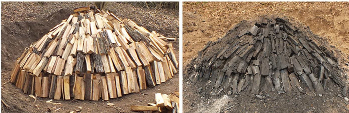
6. ábra: A fahasábokból megrakott boksa (balra) és a leszenülés után kitakart boksa (jobbra).
