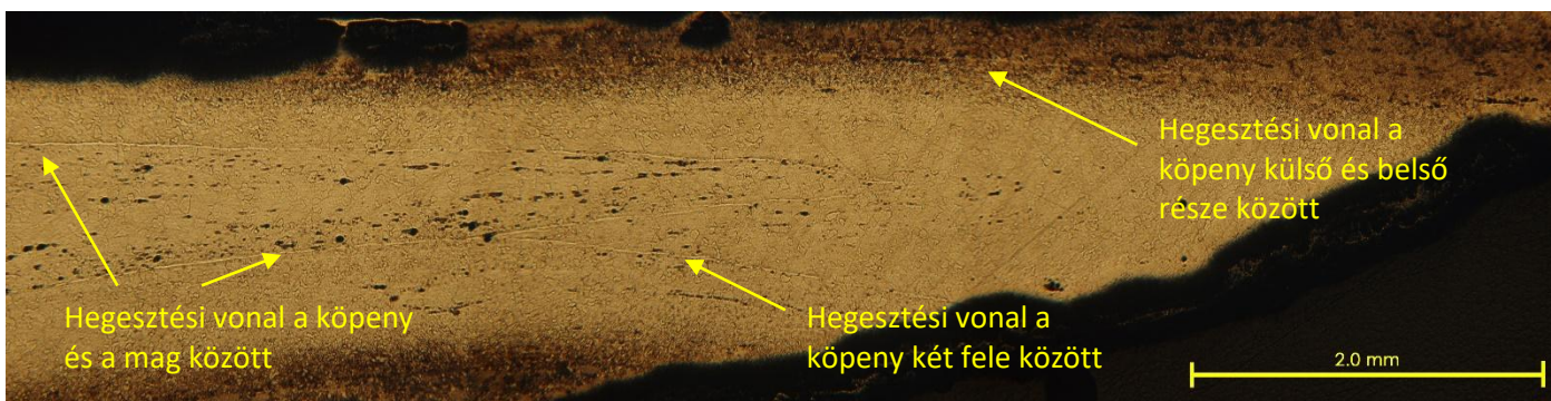
12. Ábra: Kovácshegesztési vonalak a penge éle közelében
