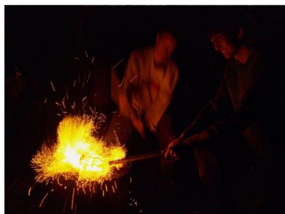
III.3. A vasbuca tömörítése
