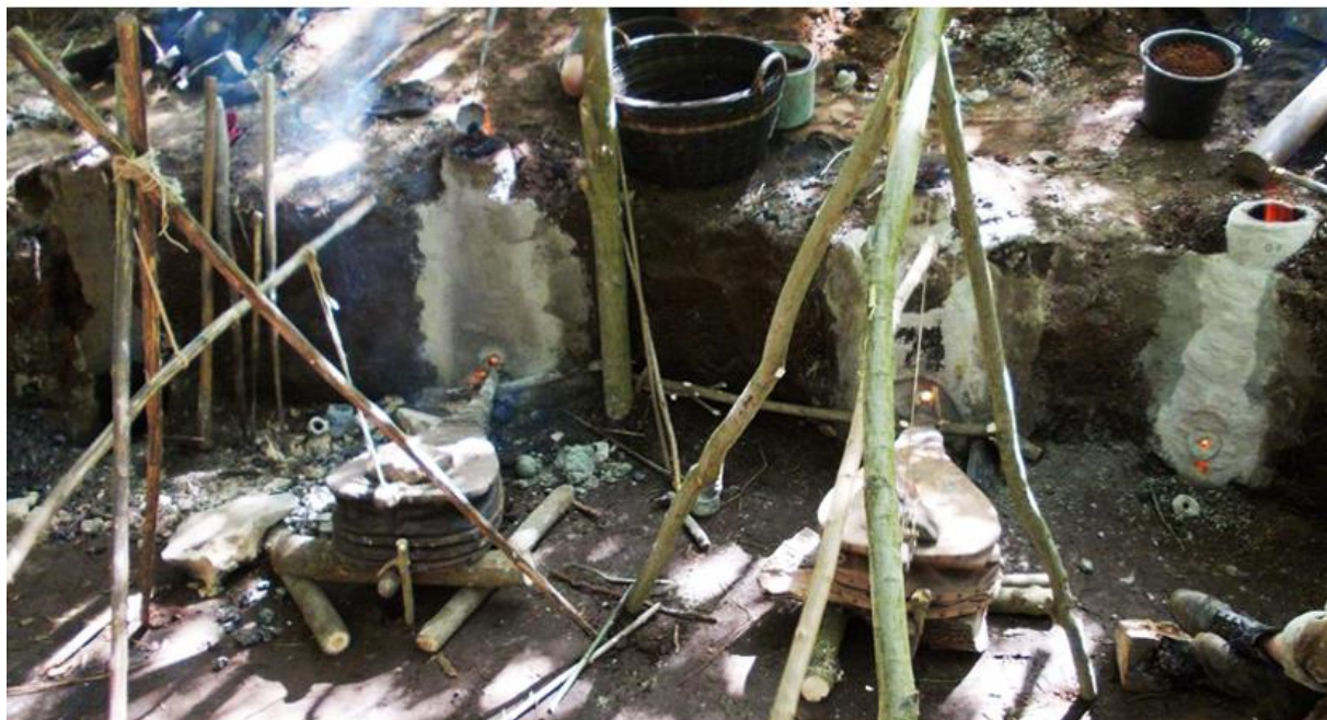
III.1. Rekonsturált fajszi típusú bucakemencék a műhelygödör oldalfalában. IV. Óskohász Tábor, 2012, Somogyfajsz.
