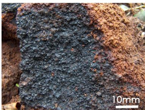
I.3. Az Aranyosi-patak által feltárt biogén gyepvasérc lencséből származó gyepvasérc darab Fe, Mn- gumókból álló makroszerkezete
