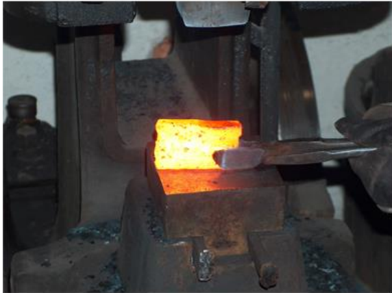
IV.1. Damaszkolt próbatest kovácsolása rugóskalapáccsal
