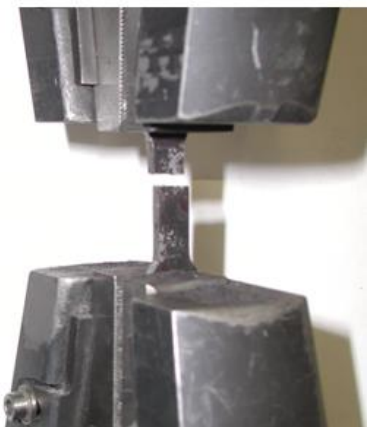
IV.5. Lapos szakítópróbatest a kereszfejekbe fogva, szakadás után
