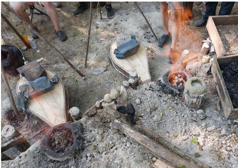
Kohósítás az 1-es és 2-es kohóban. Az 1-esbe aprószemű granulált érc, a 2-esbe nagy szemű, mésszel kevert érc került.
