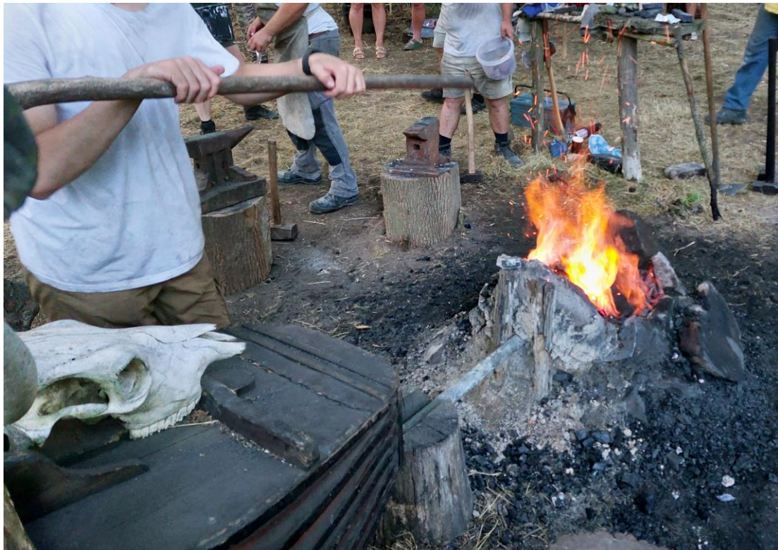
A tömörített vashucák összekovács-hegesztése. Hevítés a szokásos tábori kovácstűzhelyben.
