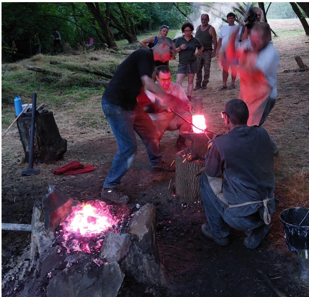
A negyedik tömörített buca rákovács-hegesztése a másik háromból összekovács-hegesztett nagy tömbhöz.
