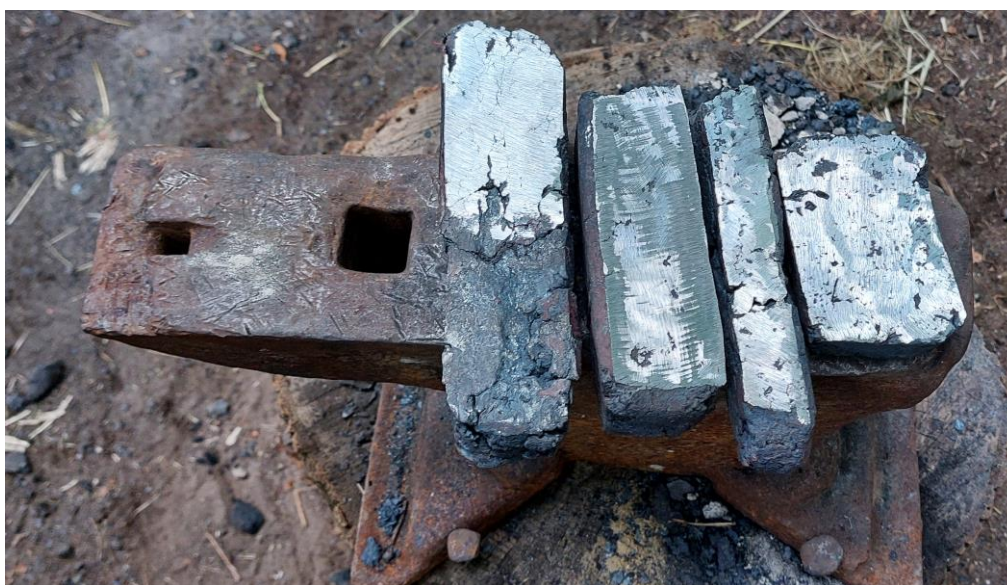
Az első kohósítási sorozat bucái sorrendben, balról jobbra az 1-4-es kohóból, sorban 1.77 kg, 1.82 kg, 0,81 kg és 0,81 kg. Flexszel, tisztítókoronggal fémtisztára csiszolt felületek a p-xrf mérésekhez
