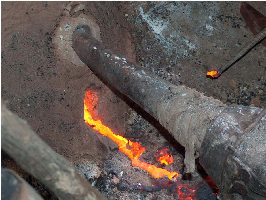
15. Kép: Salakcsapolás a harmadik próbakohósítás során
