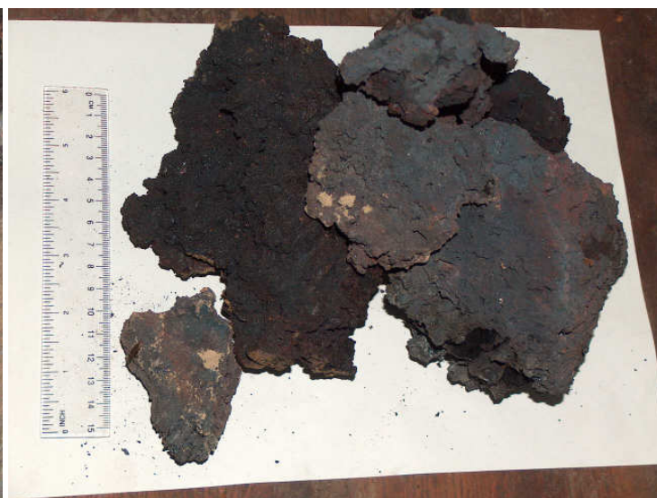
13. Kép: Az első próbakohósítás vasbucájának darabjai
