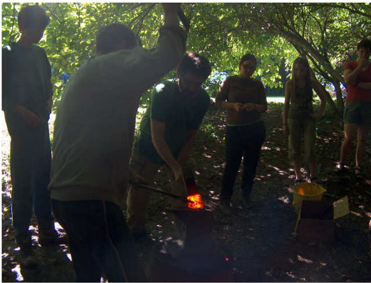
16-19 Kép: A negyedik próbakohósítás eredményeképpen kapott vasbuca megmunkálása
