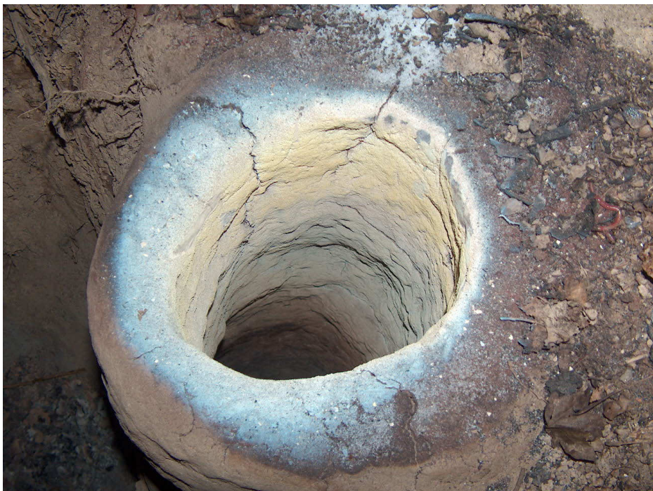
20-21. Kép: Kékes árnyalatú torokláng és sárgás-zöld por a kohó torkában és belső falazatán
