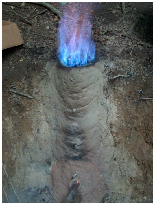
20-21. Kép: Kékes árnyalatú torokláng és sárgás-zöld por a kohó torkában és belső falazatán
