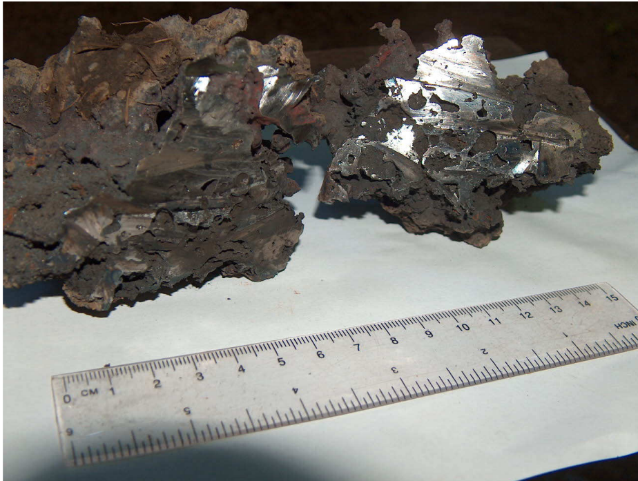
14. Kép: A második próbakohósítás eredményeképpen kapott vasbucá keresztmetszete
