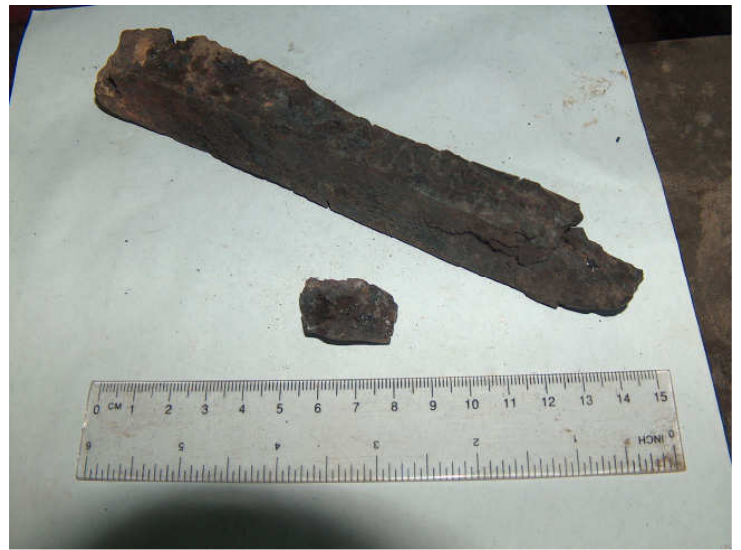
16-19 Kép: A negyedik próbakohósítás eredményeképpen kapott vasbuca megmunkálása
